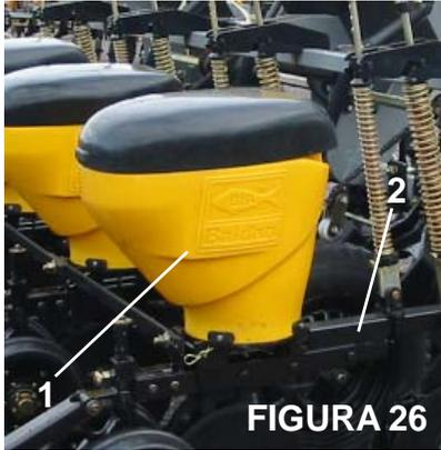
2 - Quite todas las cajas de semillas (1) de las líneas de siembra (2), a través del perno de traba (3), como **detalle "A"**, dejando la parte trasera de la sembradora libre para el montaje del kit de semillas finas como indicado a continuación:
