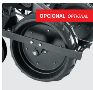
Roda compactadora de borracha. Rubber compression wheel. Rueda de compactación de goma.
