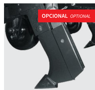
Sulcador pontiagudo com ponta removível para adubo. Furrower with removable point. Punta surcadora con punta removable.
