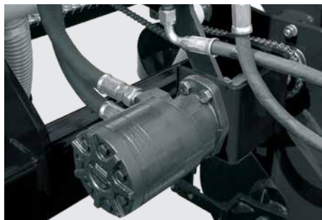
Motor hidráulico para acionamento da transmissão. Transmission by hydraulic engine. Motor hidráulico para accionamiento de transmisión.
