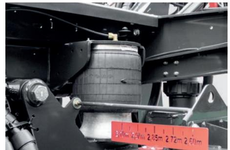
Suspensão pneumática ativa nas 4 rodas, onde melhora a performance do equipamento em terrenos ondulados, permitindo a melhor aderência dos pneus ao solo e evitando a transferência de choques ao chassis, além de facilitar a estabilização das barras.
