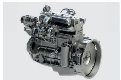
Motor MWM 4.12 TCE e possui sistema de recirculação dos gases de escape EGR para reduzir as emissões de óxidos nitrosos. Com 4 cilindros de 4,8 litros, utiliza um sistema de arrefecimento após o motor (aftercooler) e conta com uma potência de 190 cv a 2.200 RPM.
