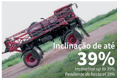
Distribuição de peso ideal entre os eixos permite pulverizar em terrenos com inclinação de até 39%.
