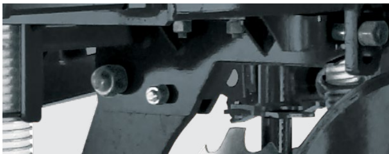
Desarme automático pino fusível. Safety pin automatic desarm. Desarme automático por fusible.
