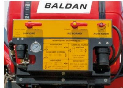
Painel de controle onde são realizadas as regulagens, dosagem de aplicação, agitação e lavagem do sistema. (Demetra com sistema inoculante).
