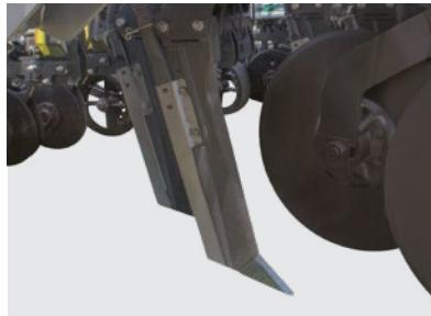
Sulcador de haste fixa adequado para plantio sobre palhada de cana-de-açúcar com dispositivo de segurança (pino fusível).
