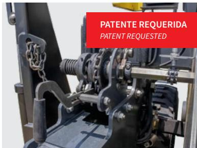
Sistema de acoplamento para arremate que permite trabalhar com apenas um dos lados da máquina.
