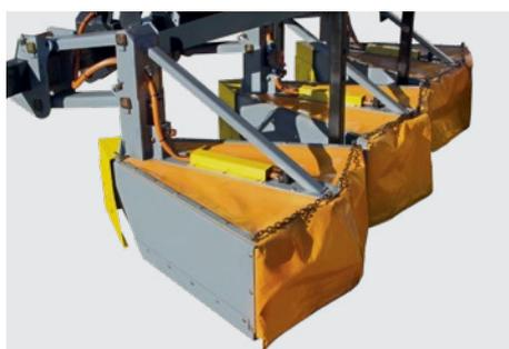
Carrinho com linhas pantográficas para a aplicação do herbicida, com roda de controle de altura com acabamento em lona, garantindo maior uniformidade na aplicação e evitando deriva.
