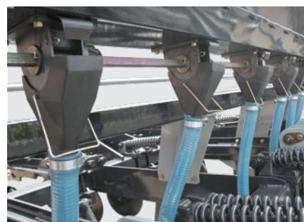
GARRA 300 (depósito de semente) sistema de distribuição de sementes por rotores helicoidais.
