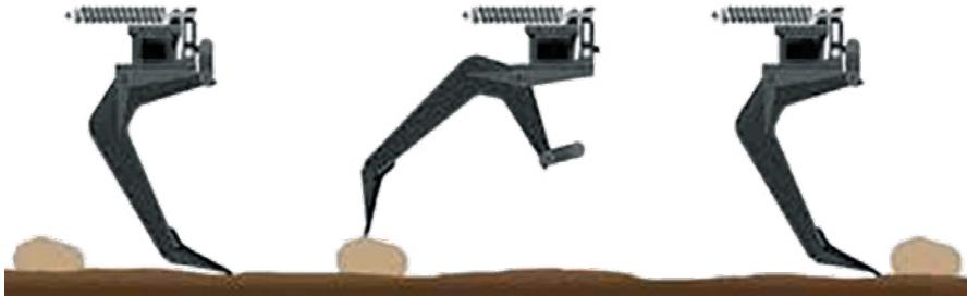
O GARRA 300 possui sistema de desarme automático das hastas, proporcionando ao operador maior comodidade de trabalho e rendimento diário e sem o uso de pino fusível, que necessita ser trocado para o rearma da haste.
