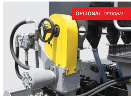
GARRA 300 (depósito de semente) motor hidráulico para acionamento da transmissão. Volante que permite a regulagem do rotor, possibilitando maior variação na distribuição de semente.
