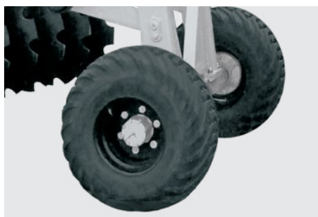
Pneu Simples 400 x 60. Single ground wheel 400 x 60. Neumático Simples 400 x 60.
