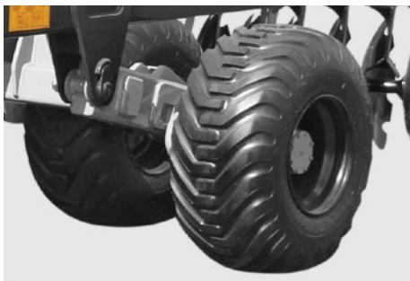
Rodeiro para transporte com pneus 400 x 60 - 14 lonas. Transport wheels 400 x 60 tyres - 14 canvases. Rueda para transporte con neumático 400 x 60 - 14 lonas.
