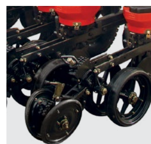
Rodas para controle de profundidade e compactação com regulagem manual. Wheels for depth control and compression with manual adjustments. Ruedas para control de profundidad y compactación con regulación manual.
