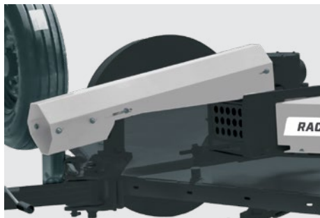
Capa de proteção do eixo cardan. Drive shaft protection. Protección para el eje cardan.
