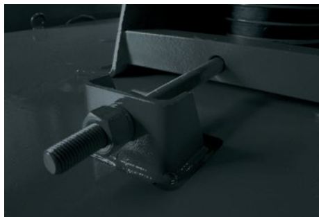
Sistema de ajuste de tensão das correias. Belt tension adjuster. Tensor para ajustar las correas.
