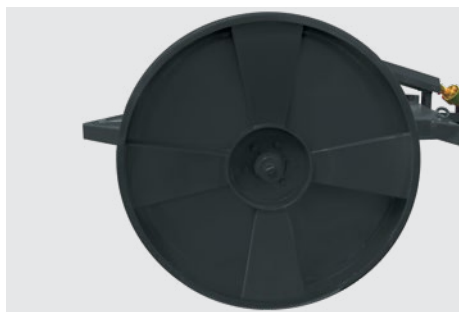
Roda reforçada para impacto de galhos com friso para que a roçadeira não se desloque no trabalho. Strong wheel that won't overreact to a bump in the field. Rueda reforzada con anillo para evitar desplazamientos laterales durante el trabajo.
