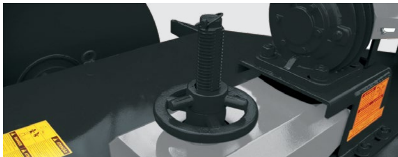
Sistema de regulagem das facas através de mandril, que regula altura de corte de 100mm a 320mm. Blade adjustment by thread axle that provide adjustment from 100mm to 320mm. Soporte para la regulación de la altura de corte de las cuchillas, desde 100 hasta 320mm.
