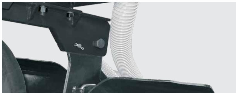
Desarme automático fusível. Safety pin automatic desarm. Desarme automático por fusible.
