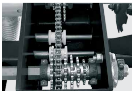
Regulagem de vazão de adubo. Fertilizer Calibration. Regulaje de flujo de abono.
