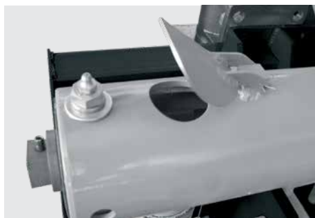
Dispositivo de segurança do adubo. Safety device of fertilizer. Dispositivo de seguridad del abono.
