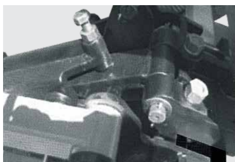
Ajuste de pressão do desarme. Pressure adjustment of disarming. Ajuste de presión del sistema de desarme.
