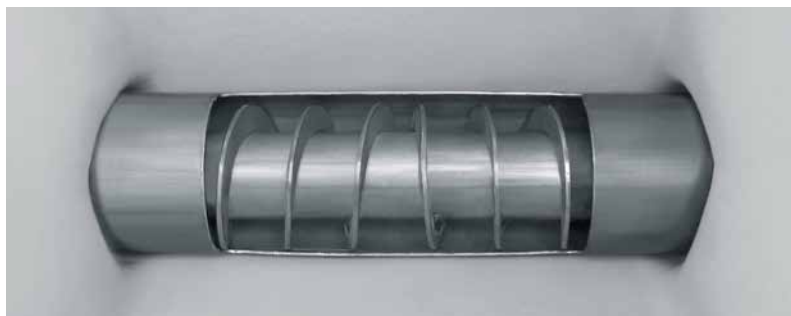
Mola helicoidal condutora de precisão. Floating spiral type fertilizer distributors. Resorte espiral conductor de abono.
