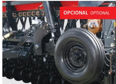
Sistema de transporte lateral mecânico e semi-hidráulico com pneu 900x16 - 10 lonas para SKADI 5000/6000 e pneu 400x60 - 14 lonas para SKADI 7000.
