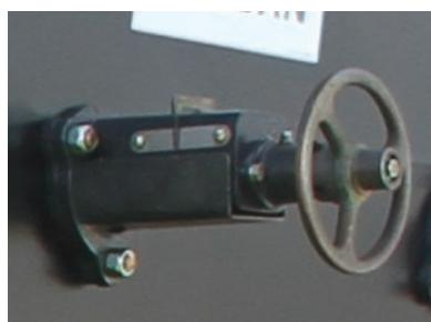
Volante para regulagem de distribuição de sementes com escala graduada através de rotor acanalado.
