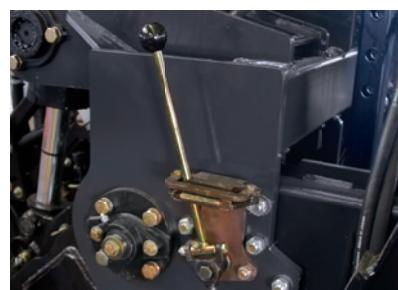
Sistema de arremate que permite trabalhar com apenas um lado da máquina.
