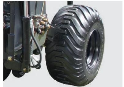
Pneu 400x60 - 14 lonas para SKADI 5000/6000 e pneu 500/60-22.5 16 PR TR-08 TL para SKADI 7000.
