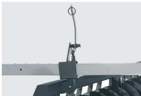
Barra de abertura e travamento. Device for opening and lock of gangs. Barra de apertura y trabamiento.
