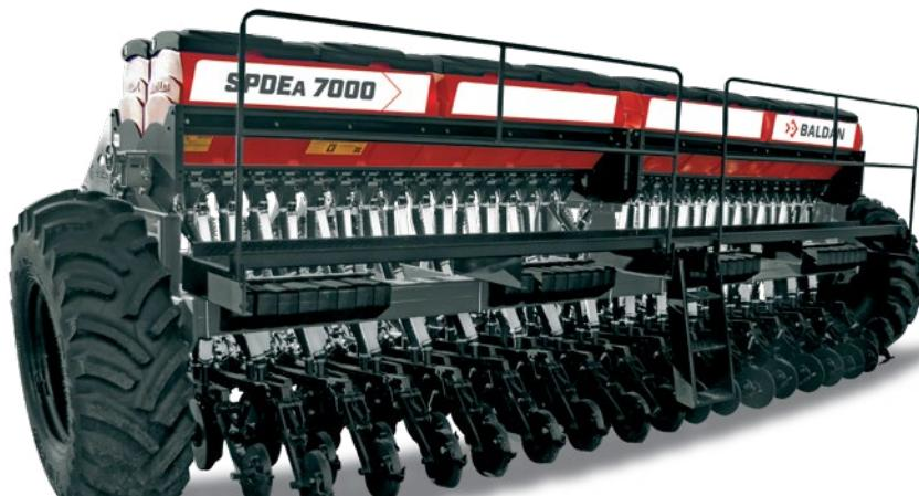
Opcional: Caixa de semente fina em aço carbono com tratamento epóxi. Discos de corte estriado de 14" (standard) ou discos de corte liso. Marcadores de linha hidráulico frontal de dupla ação com válvula sequencial. Tabela eletrônica de dosagem ETD para fertilizantes e sementes. Monitor de sementes digital PMB 400. Sistema de transporte lateral mecânico e semi-hidráulico. Carrinhos das rodas compactadoras; lisa, côncava, convexa e em "V". Friso limitador com limpador para o disco duplo.
