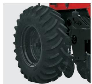
Sistema de rodado com pneu 18,4 x 30 x 12L para o menor índice de compactação ao solo e de transferência de cargas da semeadora.
