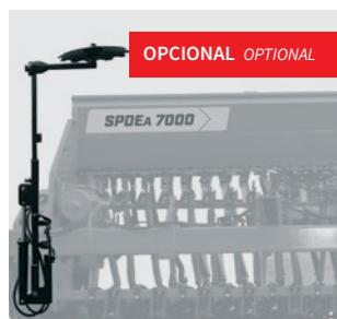
Marcadores de linha hidráulico frontal de dupla ação com válvula sequencial.
