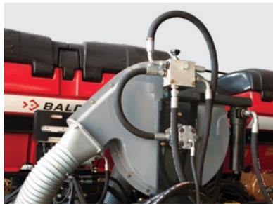
Sistema de turbina fluxo contínuo com regulagem independente do sistema de vácuo por meio da válvula centralizada
