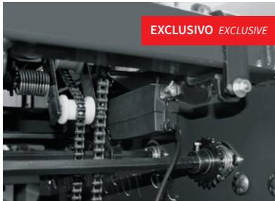
Sistema de desarme da catraca (arremate) com atuador elétrico linear com controle remoto.
