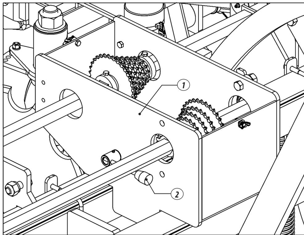
**03** - Para cambio de velocidad del recambio, retire las tuercas mariposas y arandelas (1) y la tapa del recambio (2), conforme muestra los detalle "I".
