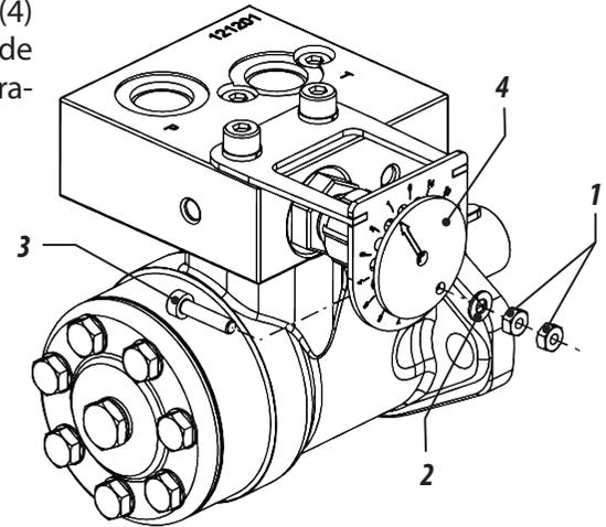
La regulación del abono se debe realizar a través de la válvula y motor hidráulico, con el tractor parado, pero en la misma rotación de trabajo. Recoger el abono durante el tiempo cronometrado para recorrer 50 metros y calcule según el ejemplo de la página siguiente.
