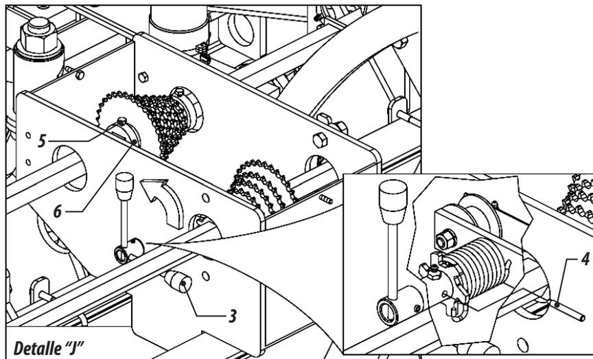
**05** - Alinee los engranajes, reaprete los tornillos (5) y posicione la cadena en los engranajes seleccionados, conforme distribución a ser efectuada, retire el perno (4) y suelte la palanca (3), conforme muestra los detalles "K".
