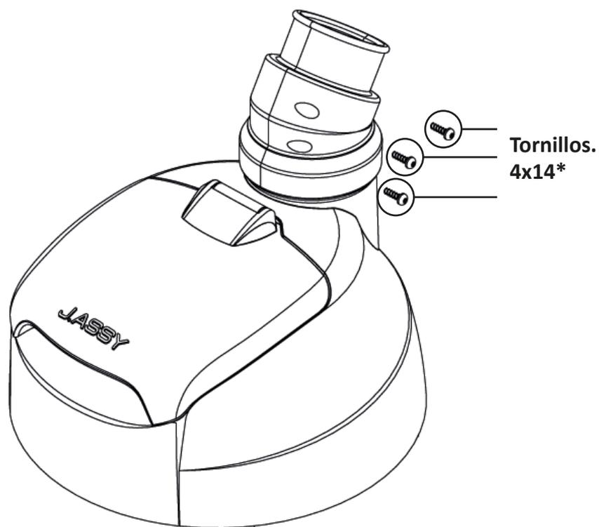
**5** Coloque la nueva boquilla y coloque los **tres tornillos Phillips 4x14** (retirados de la antigua boquilla).
