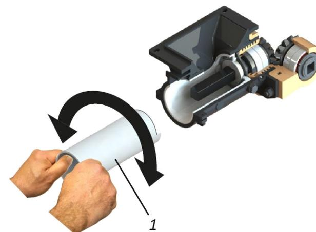
**NOTA** | El tubo de mantenimiento (1) tiene un ángulo de corte final para facilitar esta operación.
