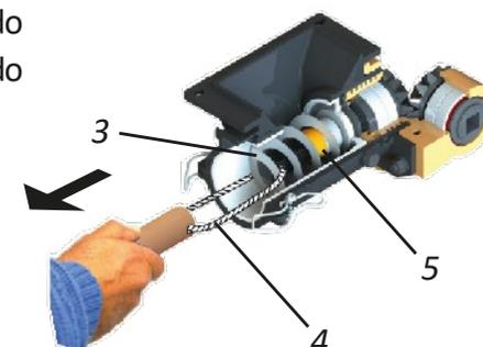
**03** - Después de la limpieza, reemplace el resorte sin fin (3), junto con el anillo de bloqueo (5), a través del tubo de fijación (4), asegurándose de que el resorte sin fin (3) y el anillo de bloqueo (5) estén bien posicionados en la base del eje impulsor (6).
