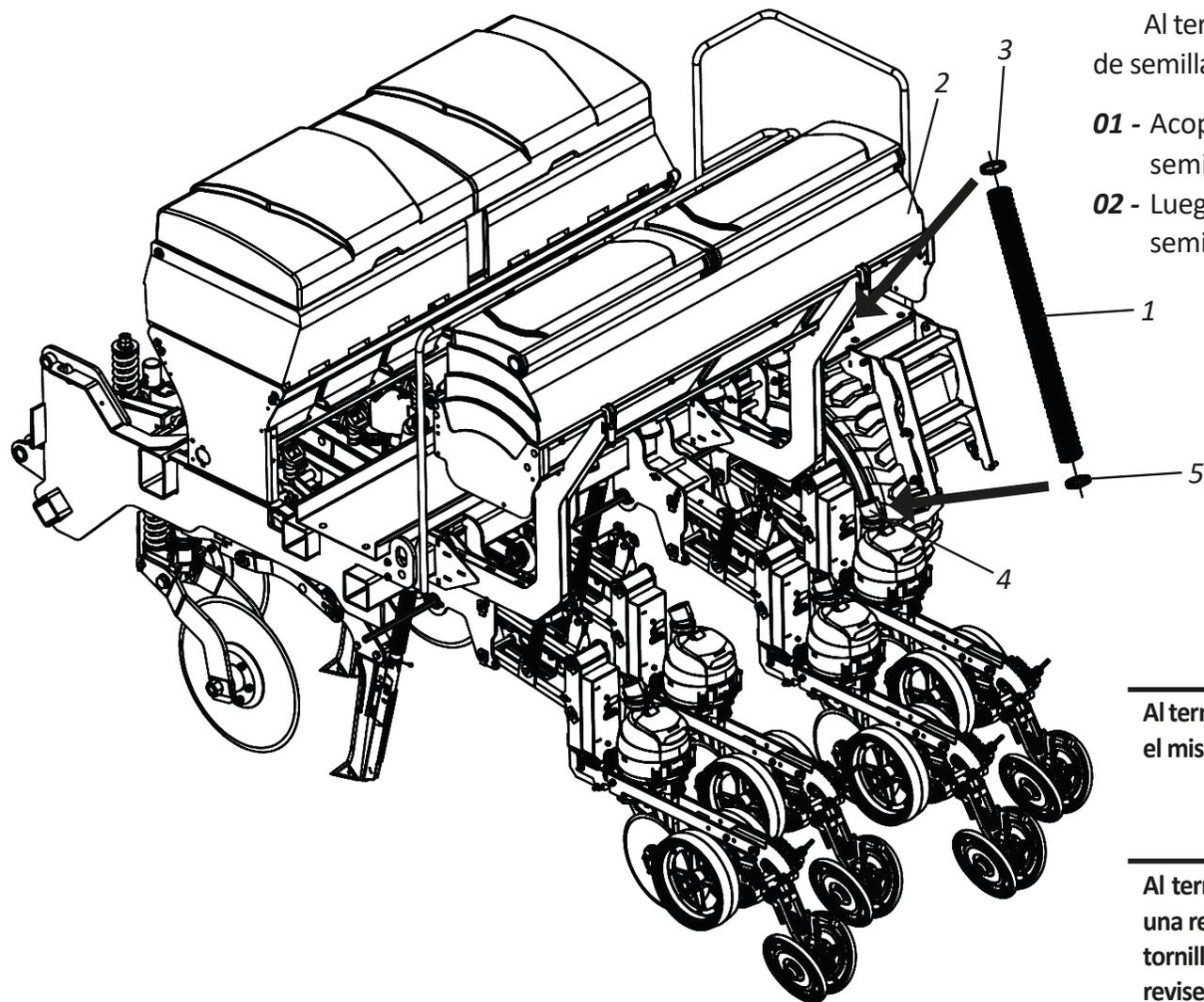
Al terminar el ensamblaje de las líneas, fije las mangueras conductoras de semillas (1), para esto, proceda de la siguiente manera:
