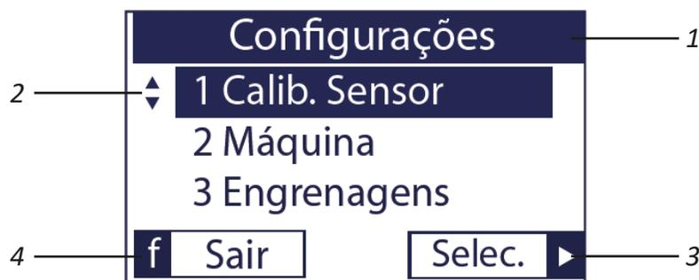
La tecla Selec.
