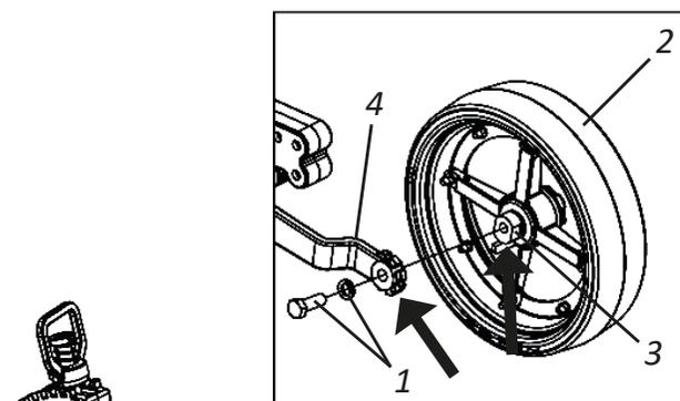
**01** - Afloje los tornillos y arandelas (1), retire la rueda (2), ajuste el punto de ajuste de la rueda (3) en el ajuste del eje de soporte de la rueda (4), luego fije la rueda (2) nuevamente con las arandelas y tornillos (1).
