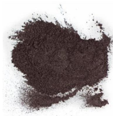
El uso del grafito es fundamental para el funcionamiento del sistema y también para la perfecta distribución de las semillas, reduciendo los dobles y los fallos, las semillas rotas y el desgaste del sistema.
