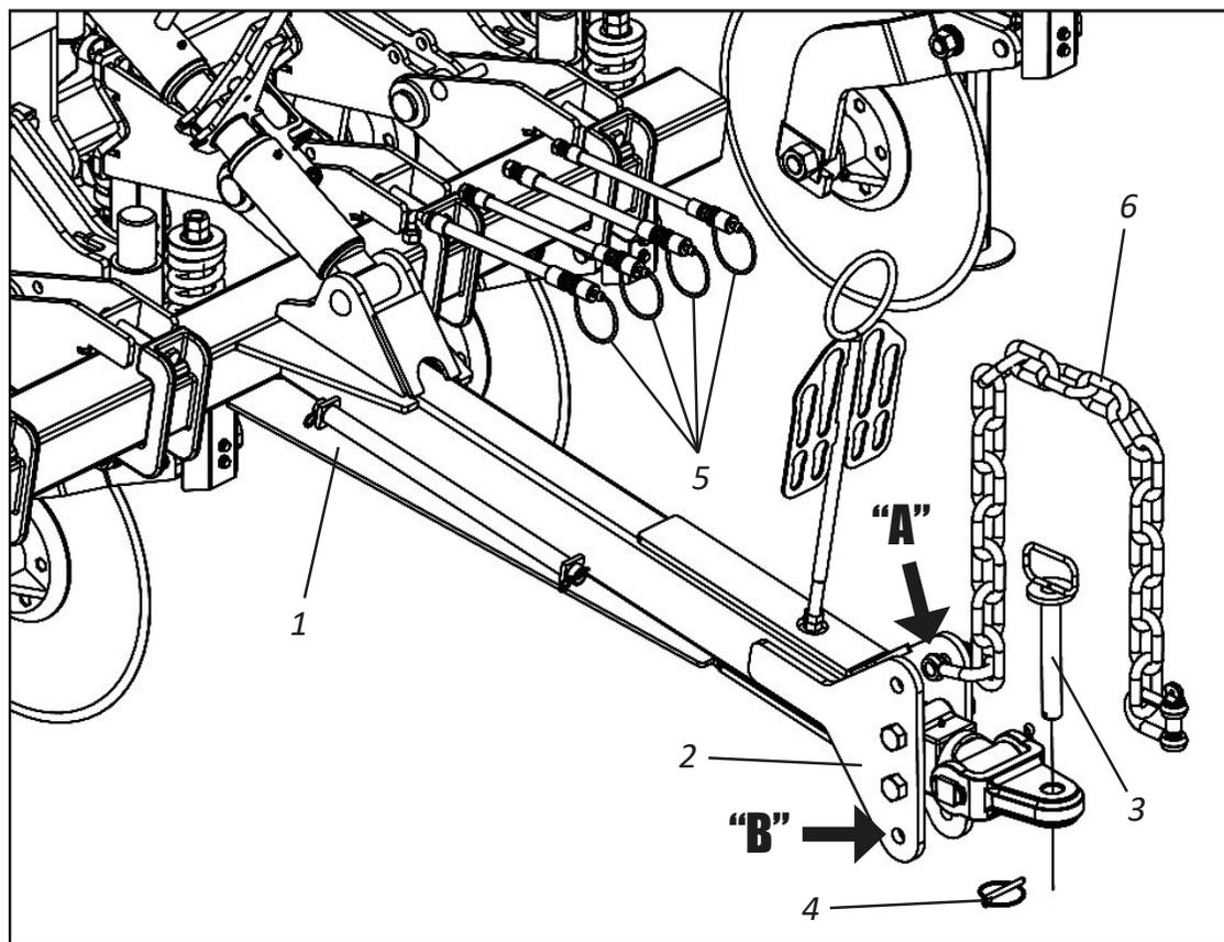
**02** - Entonces engancha la sembradora al tractor, fijándola a través del perno de acoplamiento (3) y el bloqueo (4).
