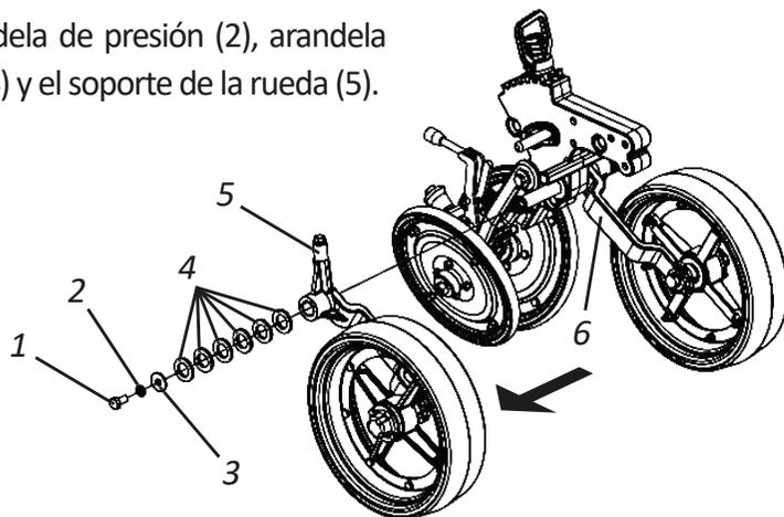
**02 -** Luego, realice el proceso inverso, primero colocando las 6 cuñas (4), luego el soporte de la rueda (5) y termine colocando la arandela plana (3), arandela de presión (2) y tornillo (1) apretándolo.
