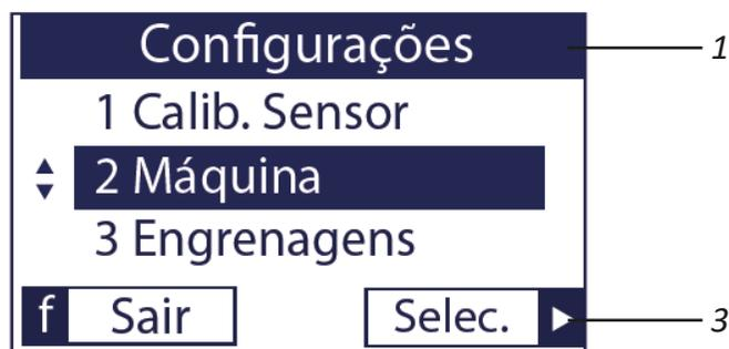
En la configuración de la máquina (1), haga clic en 'Selec' ► (2) para ingresar el número de líneas usando los botones ◄► (3).
