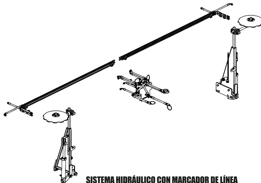
**SISTEMA HIDRÁULICO CON MARCADOR DE LÍNEA**
