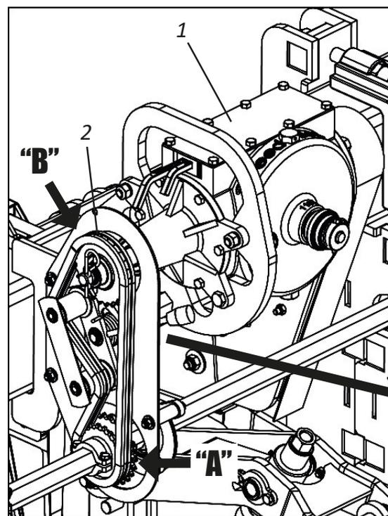
**01** - Gire el tensor (3), quitando la tensión a la cadena (2) y bloquee el tensor (3) mediante el cierre (4) situado en la parte posterior de la tapa de protección (5).
