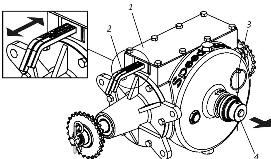
**02** - Para mover las palancas, retire la traba (3), tire de la manija (4), luego ajuste las palancas según el ejemplo anterior. Cuando se complete la combinación, regrese la manija (4) y reemplace el bloqueo (3).
