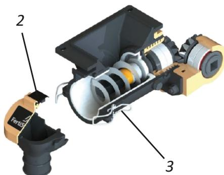
**02** - Luego, introduzca el tubo de mantenimiento (1) en movimientos rotativos, promoviendo el desplazamiento del abono al fondo del dosificador. Luego realice el mantenimiento necesario.
