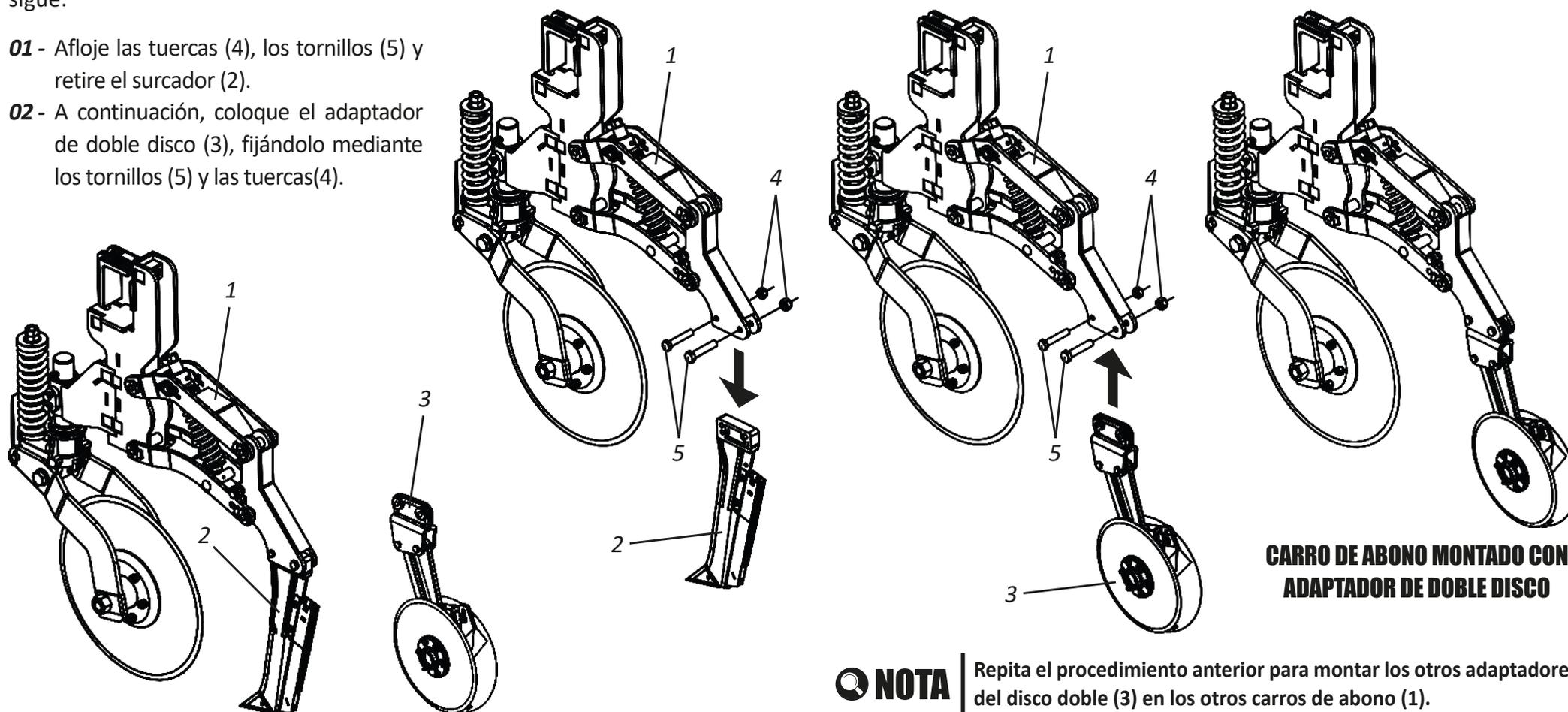
**NOTA** Repita el procedimiento anterior para montar los otros adaptadores del disco doble (3) en los otros carros de abono (1).
