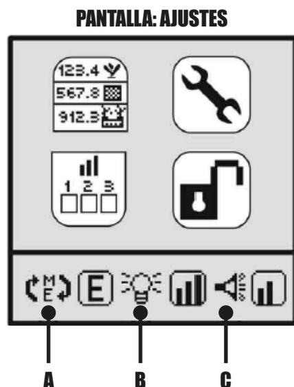
**01** - Presione
