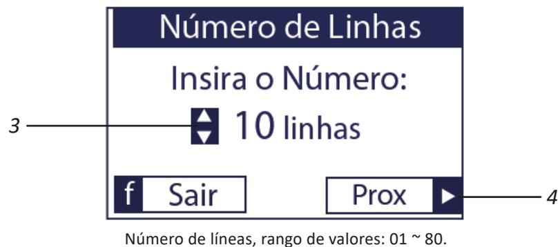
Depués de seleccionar el número de líneas contenidas en la máquina, presione la tecla ► 'Prox' (4) para seleccionar el interlineado usando los botones ◀▶ (5).
