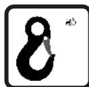
Utilice ganchos y cadenas estándar, es decir, que cumplan con las normas de seguridad. Los ganchos y cadenas utilizados para elevar la **FC 600** deben ser de GRADO 8 o 10 con una capacidad de carga compatible con el peso de la **FC 600** a levantar.
