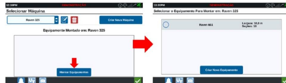
Después de reiniciar, será necesario recargar la configuración de la máquina. Seleccione Nueva Configuración y luego seleccione la máquina que está usando su CR7™.
