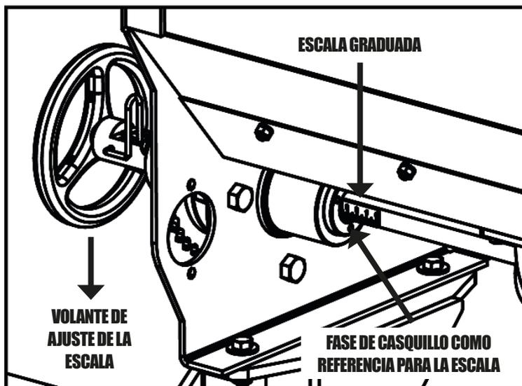
**Posiciones de apertura del rotor:** El rotor se abre cada 1 mm de acuerdo con la escala graduada fijada al eje indicado por la flecha. Use la cara del casquillo con referencia para la orientación de la escala. En la marca 0, el rotor está completamente cerrado.
