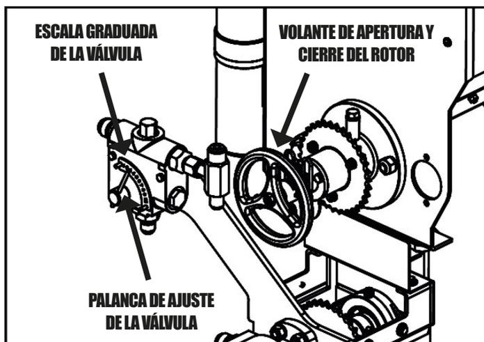
**DETALLES DE LA PALANCA Y DE LA ESCALA DE AJUSTE DE LA VÁLVULA**
