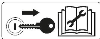
Retire la llave de encendido antes de realizar cualquier tipo de mantenimiento en el GARRA 300. Se protege de posibles heridas o muerte, causados por una partida imprevista del GARRA 300. Si el GARRA 300 no está debidamente enganchada, no arranque el tractor.
