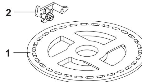
**FIGURAS 12****SUSTITUCION DEL GATILLO DOBLE POR EL GATILLOS SIMPLE ( FIGURA 13 )**
