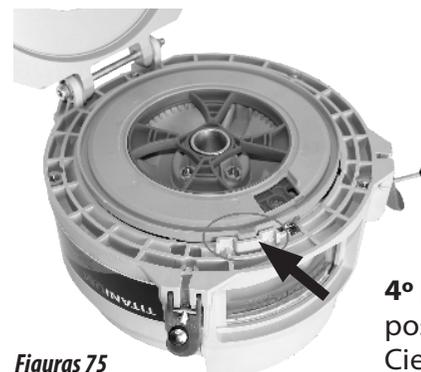
**4° Paso:** Ajuste el anillo adaptador al disco, obedeciendo el posicionamiento. Cierre la contra base, bloquee el sistema.
