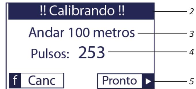
Al iniciar la calibración del sensor (2), la máquina debe moverse exactamente 100 metros (3) y detenerse.
