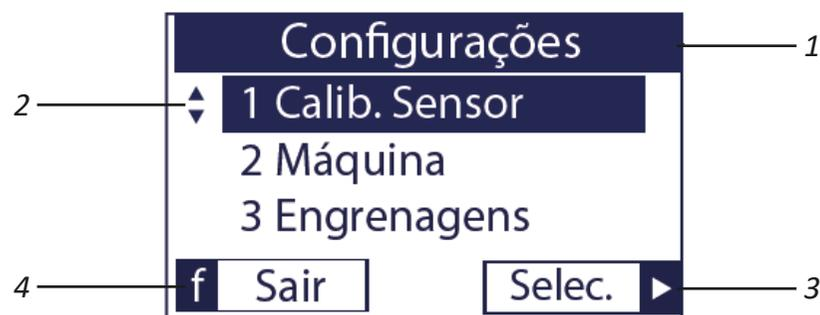
La tecla Selec. ► (3) se utiliza para seleccionar el elemento resaltado. Simplemente haga clic en la tecla "F" (4) para salir del menú de configuración.
