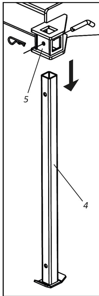
**02** - A continuación, retire los soportes traseros (4) del montante (5) y colóquelos en posición horizontal, fijándolos con los pasadores (6) y trabas (7).
