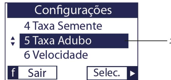
La pantalla F2 (1) indica la dosis de abono (2) en kg por hectárea obtenida con una relación de transmisión específica. Las tasas de abono se calculan de acuerdo con la calibración del abono, la configuración del engranaje (3) y el espacio entre líneas. Las teclas ▼ y ▲ (4) permiten al usuario navegar entre las opciones de tasa en Kg/ha.
