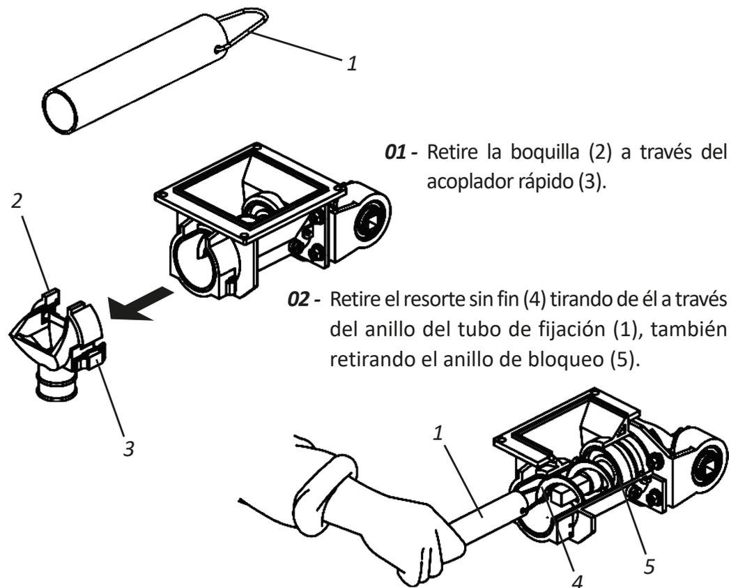
**03** - Después de la limpieza, reemplace el resorte sin fin (4), junto con el anillo de bloqueo (6), a través del tubo de fijación (1), asegurándose de que el resorte sin fin (4) y el anillo de bloqueo (6) estén bien posicionado en la base del eje impulsor (7).
