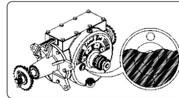
Complete el nivel de aceite diariamente. Cambie el aceite de la caja de velocidad (Speed Box) después de las primeras 30 horas de trabajo, luego cada 1500 horas, siempre usando aceite mineral ISO VG 150 a 40 °C (cantidad de aceite usado 1.8 litros). Use sólo el fusible original de fábrica, ya que sólo éste tiene una dureza controlada.
