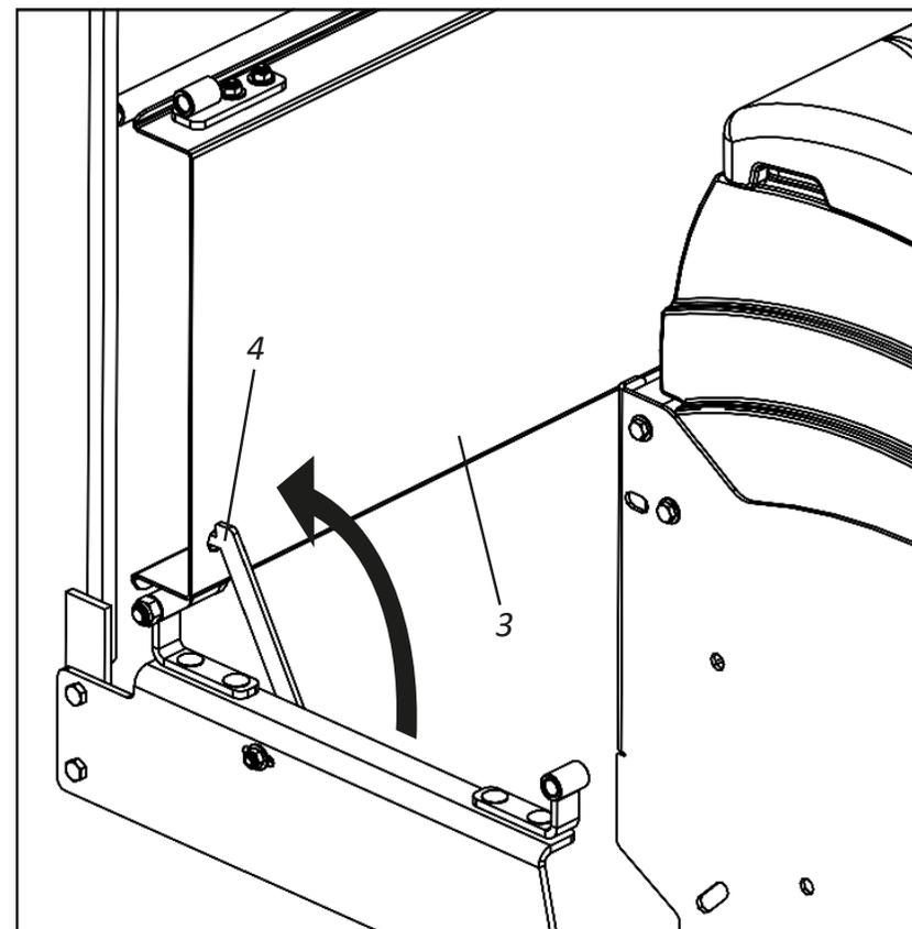
**⚠ ATENCIÓN** Articule la palanca (4) en ambos lados de la sembradora para bloquear y apoyar mejor la plataforma articulada (3).
