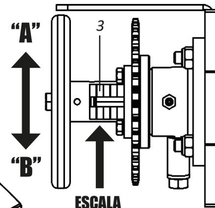
**04** - Al final del ajuste, bloquee el volante (1) a través de la traba (2).
