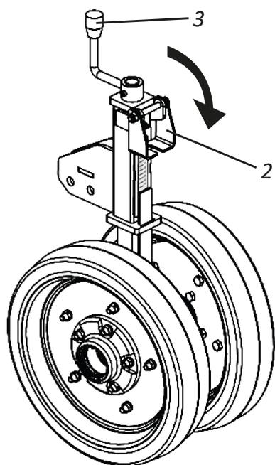
**02** - A continuación, gire la manivela (3) comprobando la escala (4) para la profundidad deseada.
