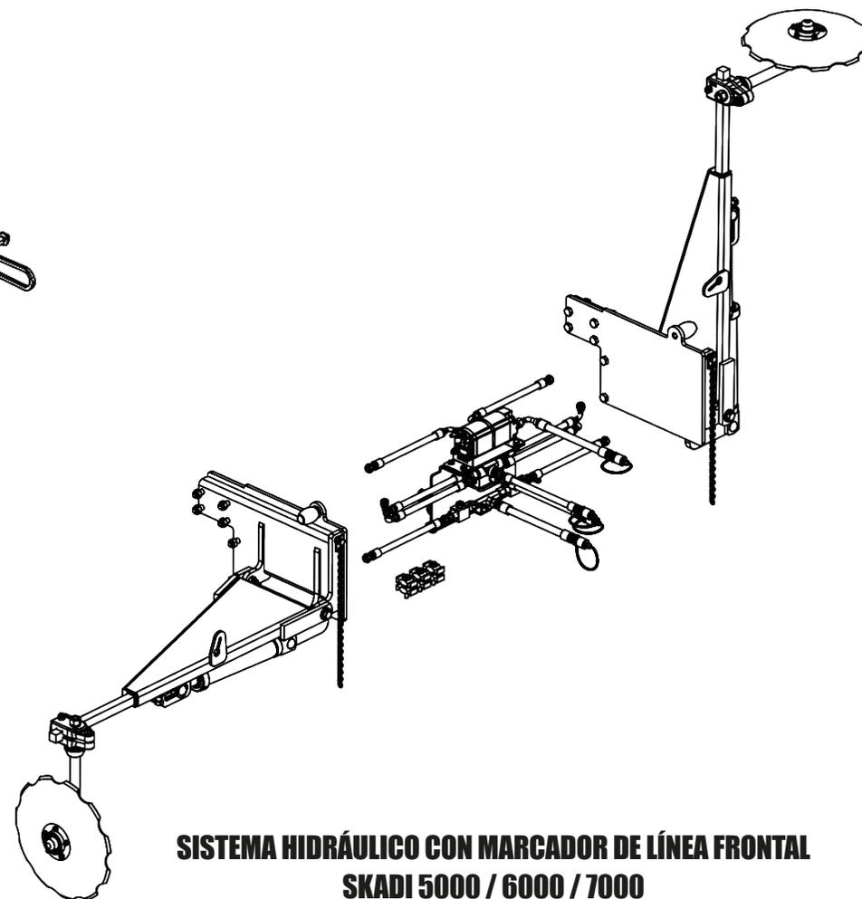
**SISTEMA HIDRÁULICO CON MARCADOR DE LÍNEA FRONTAL
