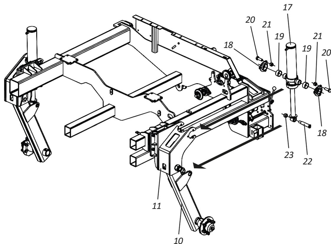
**Montaje****Montaje del transporte lateral (Opcional) - Parte III**
