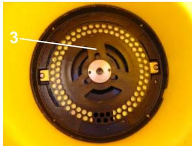
2 - Seleccione el disco de siembra deseado y proceda el montaje del mismo en la caja de semilla. Verifique la colocación de los anillos según el disco distribuidor de semilla de la siguiente forma:
