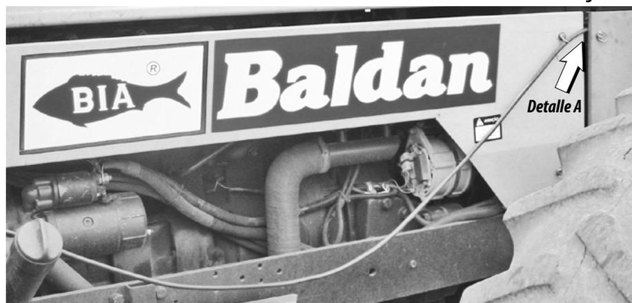
43 - Unir los cables negativo - negro (3) y positivo - blanco (4) en la batería del tractor (5). Detalle "B". FIGURA 26 y 27.
