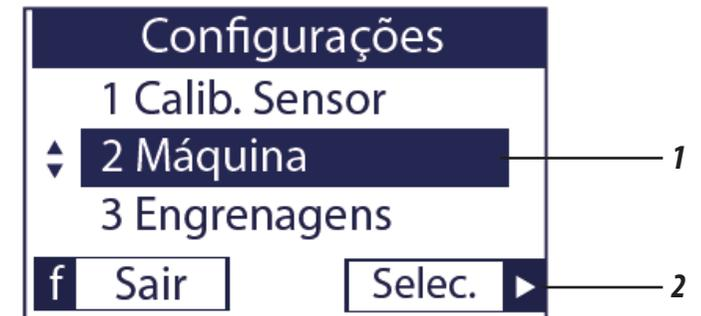
En la configuración de la máquina (1), haga clic en 'Selec' ► (2) para informar el número de líneas mediante los botones ▲▼ (3).
