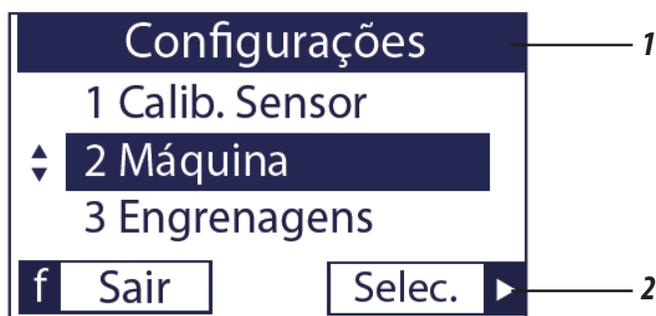
En la configuración de la máquina (1), clique en 'Selec' ► (2) para ingresar el número de líneas usando los botones ▲▼ (3).
