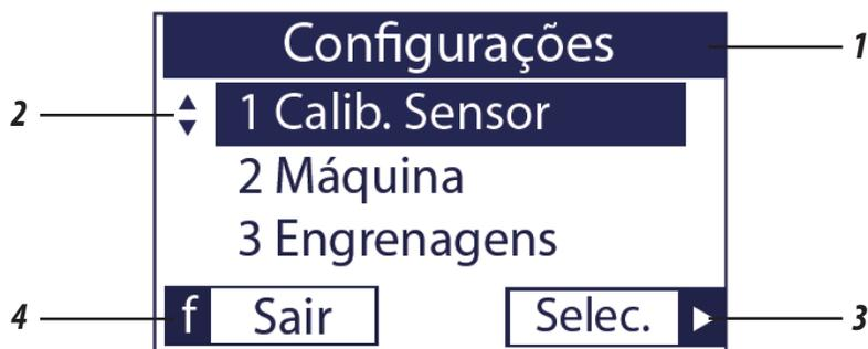
La tecla Selec.
