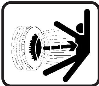
• Nunca realice soldaduras en la llanta con el neumático colocado; el calor puede causar el aumento de la presión de aire y provocar la explosión del neumático.
