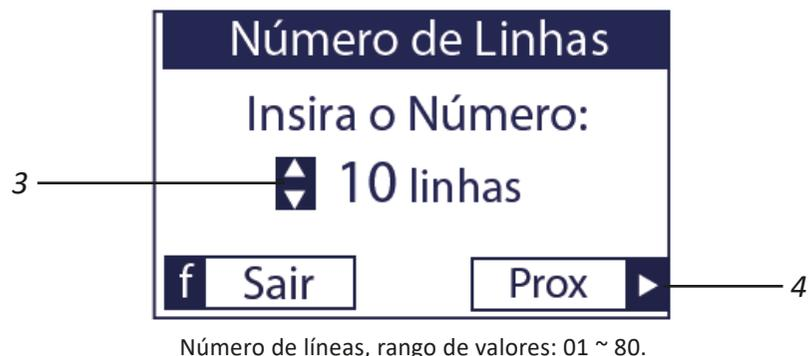
Después de seleccionar el número de líneas contenidas en la máquina, presione la tecla ‘Prox’ ► (4) para seleccionar el interlineado usando los botones ◀▶ (5).
