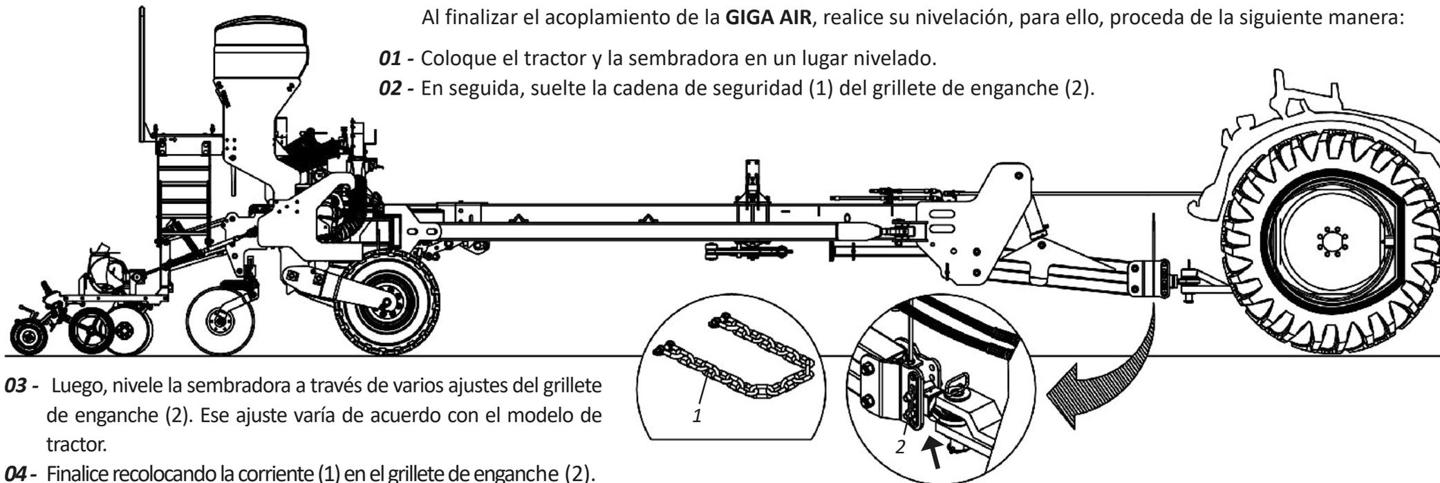
03 - Luego, nivele la sembradora a través de varios ajustes del grillete de enganche (2). Ese ajuste varía de acuerdo con el modelo de tractor.
