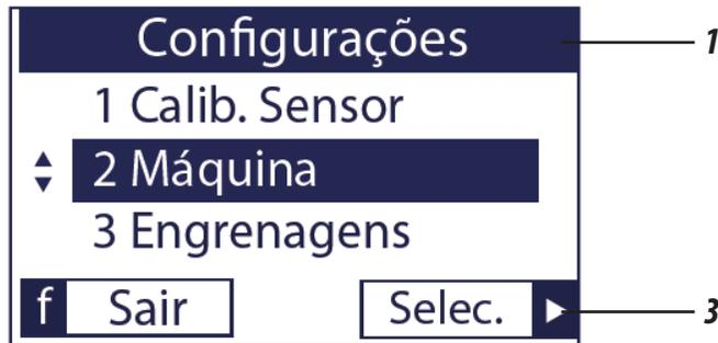
En la configuración de la máquina (1), haga clic en “Seleccionar” ► (2) para informar el número de líneas mediante los botones ◀▶ (3).
