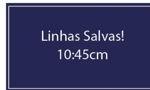
Después de seleccionar el número de líneas contenidas en la máquina, presione la tecla 'Prox' ► (4) para seleccionar el espaciado de línea usando los botones ▲▼ (5).
