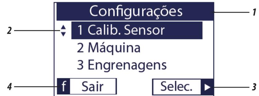
La tecla Seleccionar.
