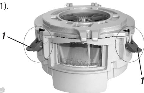
**3º Paso:** al colocar el nuevo disco certifique de estar colocándolo en la posición correcta. Encaje el orificio central del disco en el buje de centralización.
