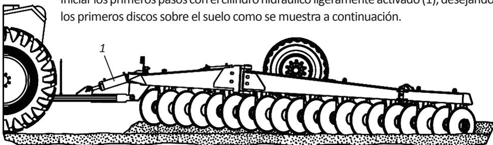
Después del tercero o cuarto pase, el cilindro hidráulico (1) debe accionarse más haciendo que todos los discos toquen el suelo, como se muestra en la figura a continuación.
