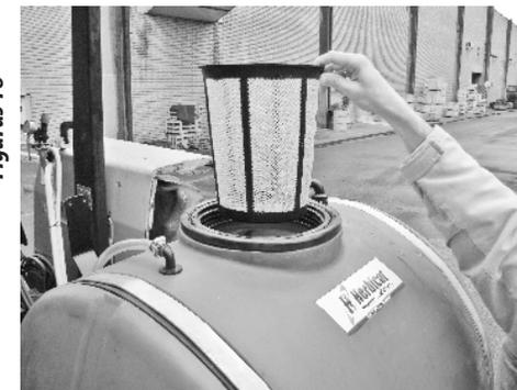
03 - Faça a limpeza no depósito e nos componentes, em seguida lave-os com água corrente. Depois monte todos novamente.
