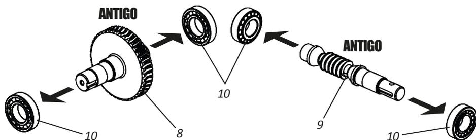
**05** - Depois, coloque os rolamentos (10) no eixo coroa (11) e pinhão sem fim (12) novos.
