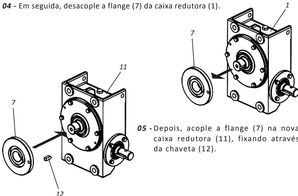
**05** - Depois, acople a flange (7) na nova caixa redutora (11), fixando através da chaveta (12).
