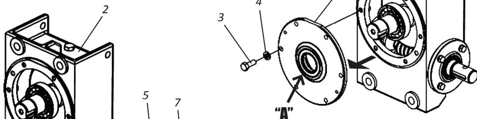
**02** - Em seguida, solte a tampa menor (5) da caixa redutora (2) através dos parafusos (6) e arruelas de pressão (7). *Obs: Repare que o retentor estará fixado na tampa menor (5), conforme mostra o detalhe "B".*
