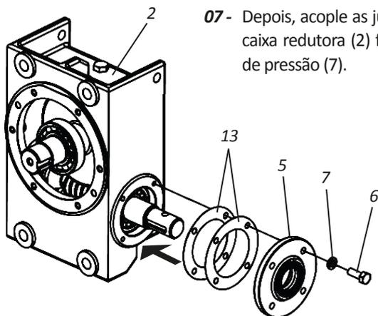
**07-** Depois, acople as juntas de papel (13) e a tampa menor (5) na caixa redutora (2) fixando através dos parafusos (6) e arruelas de pressão (7).
