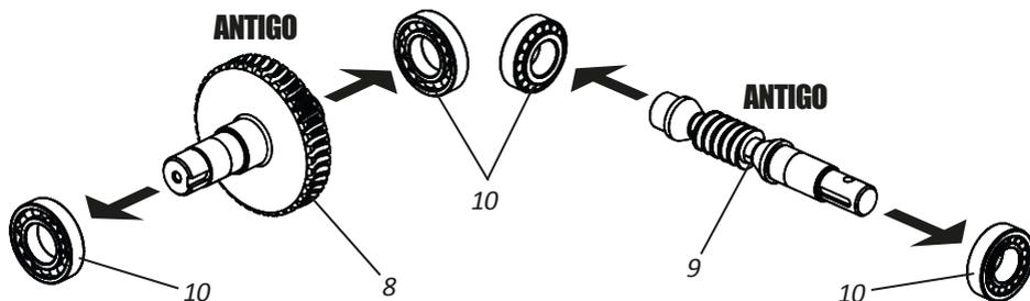
05 - Depois, coloque os rolamentos (10) no eixo coroa (11) e pinhão sem fim (12) novos.
