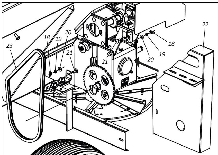
**▪ Manutenção****• Troca da caixa redutora DCF-CO (Motor Hidráulico) - Parte VIII**
