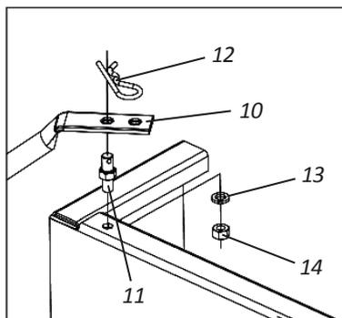
**04-** Em seguida, fixe as hastes (10) no DCF-CO, através do eixo (11), trava (12), arruela de pressão (13) e porca (14).
