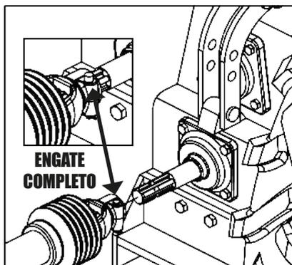
Acople a flange no eixo da TDP do trator observando que o engate só se completará quando a trava (1) saltar.
