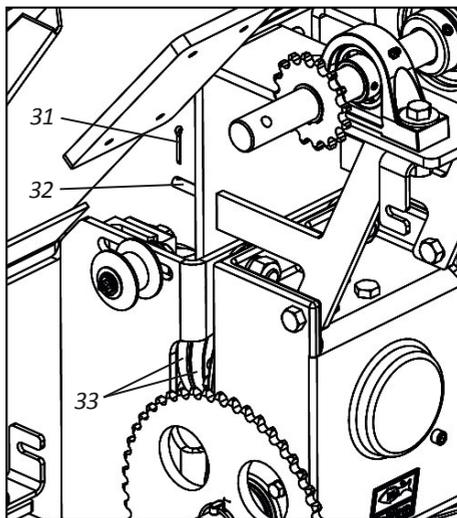
**▪ Manutenção****• Troca da caixa redutora DCF-CO (Motor Hidráulico) - Parte IV**
