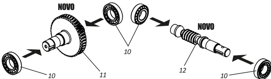
06 - Em seguida, recoloca ao mesmo tempo o eixo coroa (8) e o pinhão sem fim (9) na caixa redutora (2) ajustando-os.
