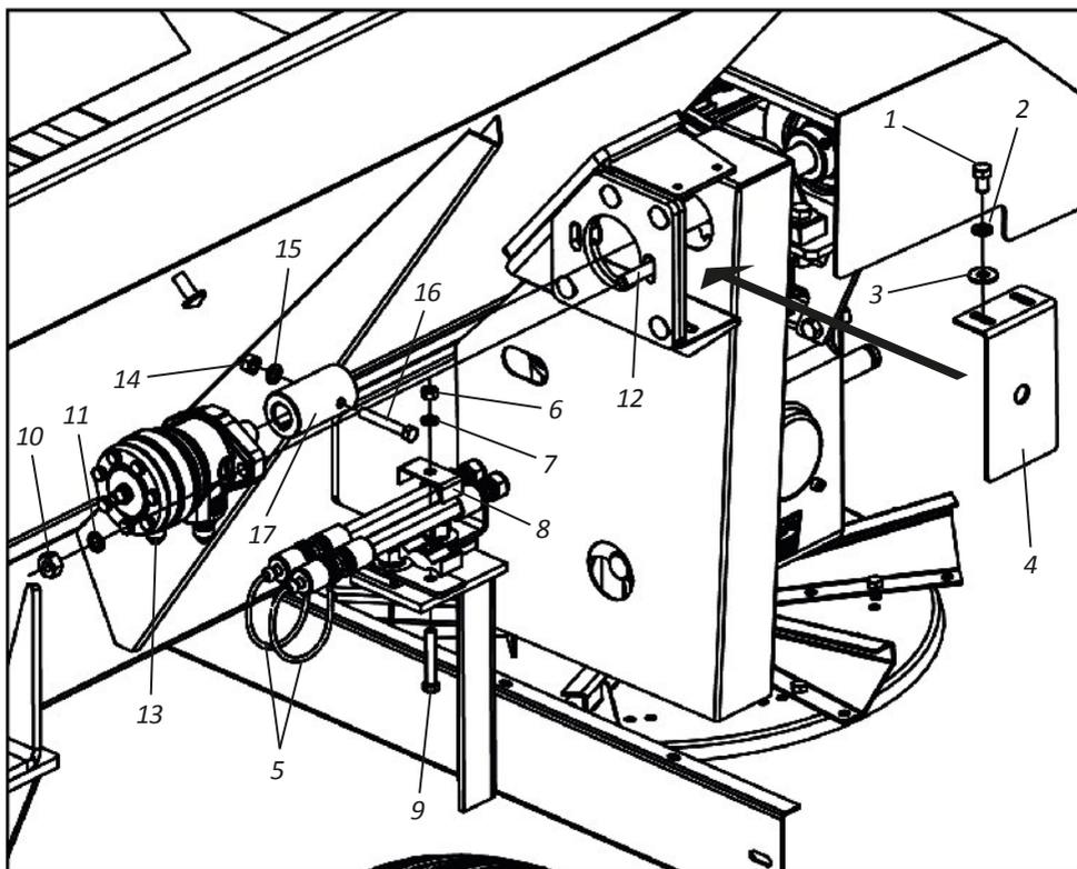
**▪ Manutenção****• Troca da caixa redutora DCF-CO (Motor Hidráulico) - Parte II**
