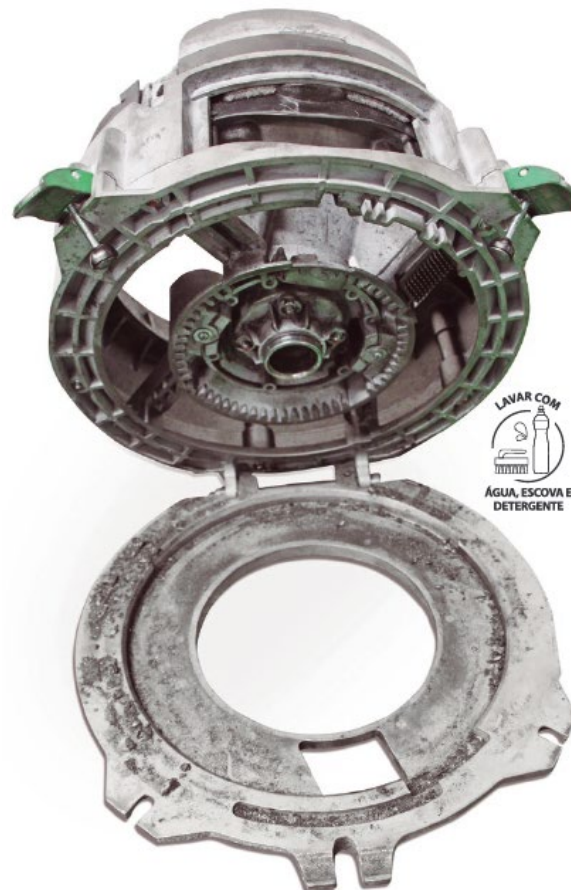
Contrabase do dosador TITANIUM sujo de grafite.
