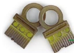
**Poliflow** com desgaste, necessidade de troca.
