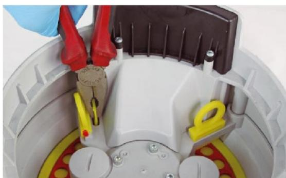
Antipulo com desgaste, necessidade de troca.
