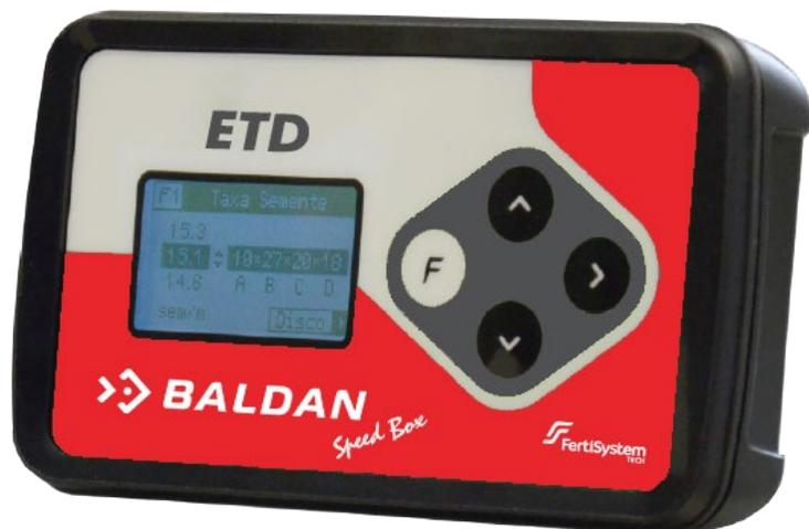
O **ETD** é um dispositivo eletrônico acoplável em plantadoras, semeadoras e adubadoras para auxiliar o operador na configuração da melhor relação de engrenagens para que ocorra a dosagem correta de sementes e fertilizantes, de acordo com as necessidades de cada área/talhão, a partir das regulagens feitas previamente a campo e calibragens antes do plantio.
