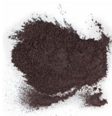
O uso do grafite é fundamental para o funcionamento do sistema e também para perfeita distribuição das sementes, reduzindo duplos e falhas, sementes quebradas e desgastes do sistema.
