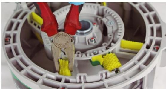
02 - Com um alicate, encaixe o ANTIPULO por dentro da base e puxe até encaixar totalmente.
