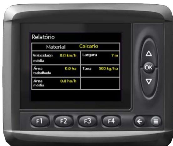
8 - Caso o sensor de velocidade da roda não esteja funcionando, aperte OK e na opção seletor velocidade distribuição, selecione MANUAL.
