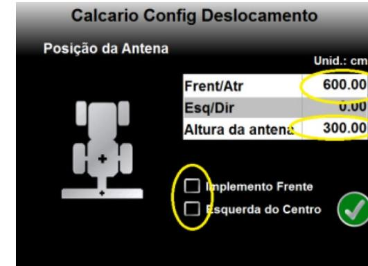
16 - Em seguida, introduza em CM a distância da antena a FERTILIZA (600) → clique em ✓ para confirmar. Na tela RAVEN CONFIG DESLOCAMENTO, selecione ALTURA DA ANTENA → introduza em CM a altura da antena ao solo (350) → clique em ✓ e ✓ para confirmar.
