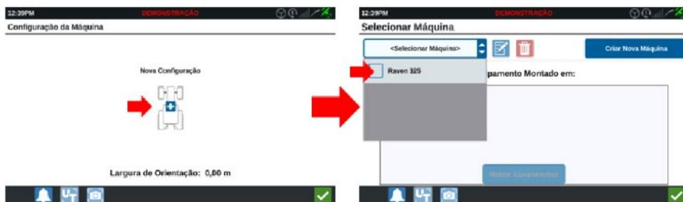
**CONFIGURAÇÃO DA MÁQUINA NO CR7 - SISTEMA RAVEN CR7 / ISOBUS - PARTE VIII****DELETAR EQUIPAMENTO COM RODAS NÃO ACOPLADO**
