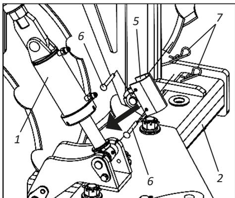
**02** - Em seguida, coloque a trava (5) no cilindro hidráulico (1) do cabeçalho (2), fixando-a com os pinos (6) e travas (7).
