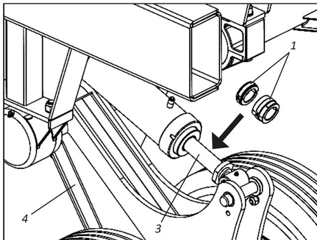
**04** - Ao terminar o trabalho, retire os anéis limitadores (1) dos cilindros hidráulicos (3) do rodeiro (4) e fixe-os novamente no montante (2).
