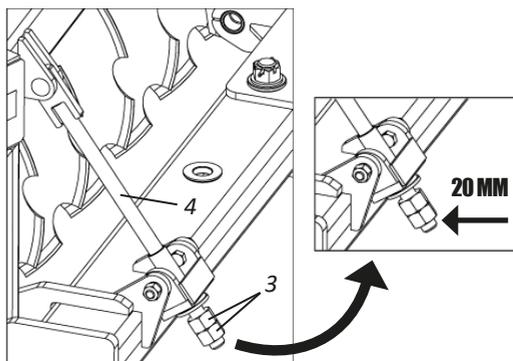
**04** - Depois, faça o acionamento para levante da grade e observe se a **GTCR** está posicionada na dianteira ou na traseira.
