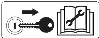
Retire a chave de ignição antes de realizar qualquer tipo de manutenção na LT. Proteja-se de possíveis ferimentos ou morte, causados por uma partida imprevista da LT.
