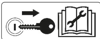
Retire a chave de ignição antes de realizar qualquer tipo de manutenção na MOVEIRE. Proteja-se de possíveis ferimentos ou morte, causados por uma partida imprevista da MOVEIRE.
