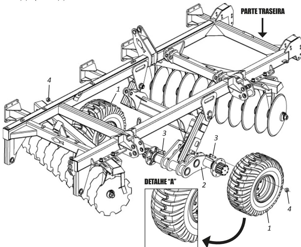
**⚠ ATENÇÃO** | Todos os pneus devem ser montados antitracionados ou seja, com as garas voltadas para a frente da MOVERE conforme mostra o detalhe "A".
